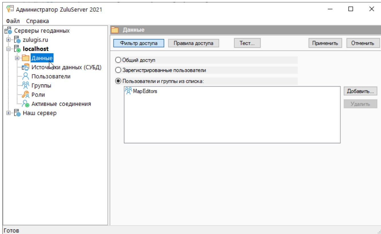
Рисунок 10.28. Окно фильтра доступа
