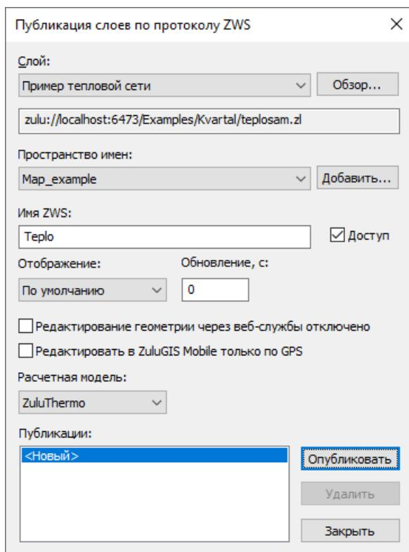
**Рисунок 16.6. Диалог Публикация слоев по протоколу ZWS**
