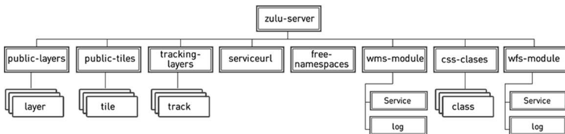
**Рисунок 13.1. Структура wms.xml**
