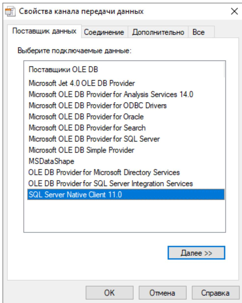
**Рисунок 8.4. Выбор драйвера для подключения**
