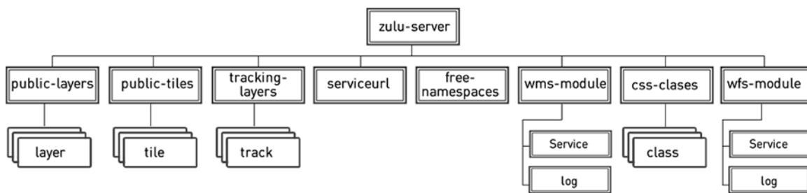
Рисунок 13.1. Структура wms.xml
