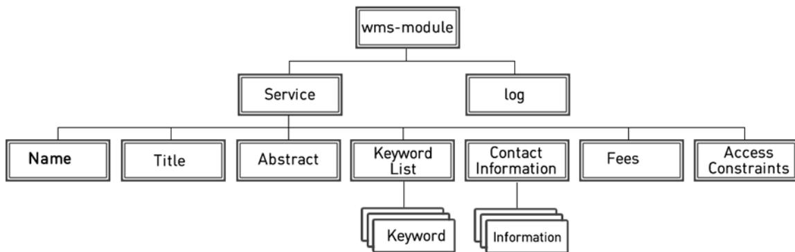
**Рисунок 13.8. Структура wms-module**
