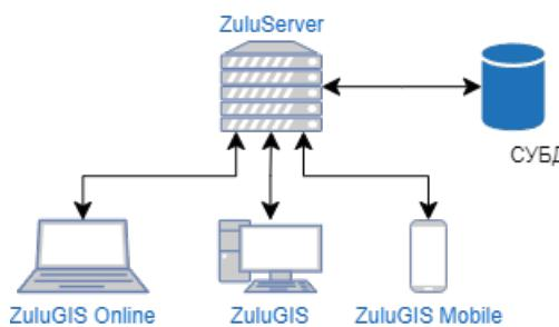
**Рисунок 8.1. Схема взаимодействия клиентов ZuluServer и СУБД**
