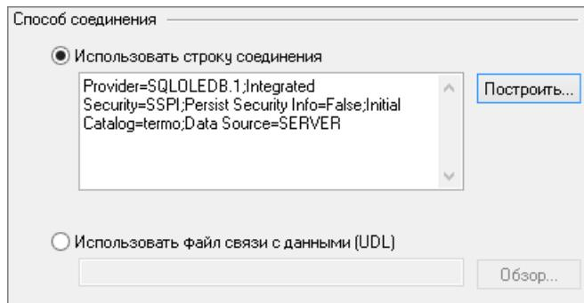
**Рисунок 8.2. Способы присоединения Соединения ADO(OLE DB)**
